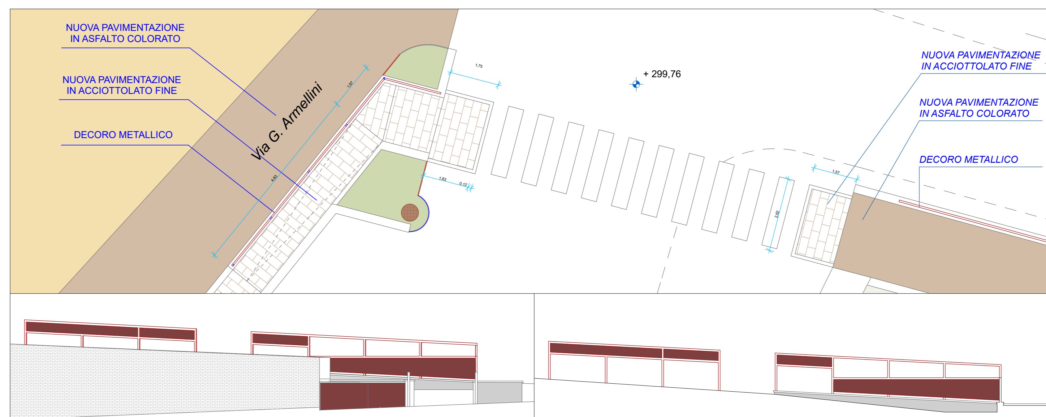
SISTEMAZIONE ATTRAVERSAMENTO STRADALE E INGRESSO PERCORSO PEDONALE VIA ARMELLINI
